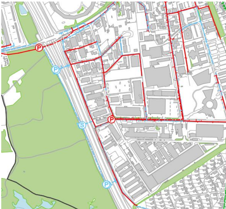
Figur 1. Afløbssystem i Bagsværd Erhvervs kvarter. Blå: regnvand, rød: spildevand
